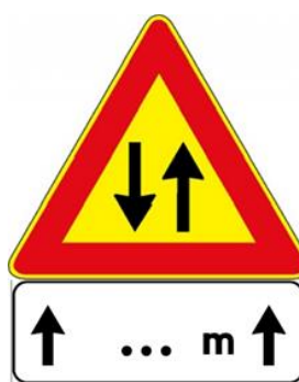
Cartello Fig. II 387 art. 31 con cartello integrativo modello II 2 art. 83 di estensione da installarsi sulla corsia non deviata
