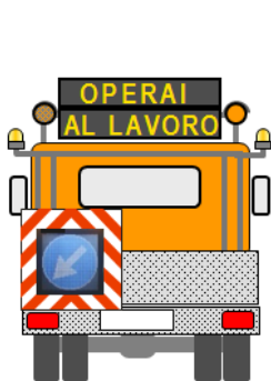
Figura 7: esempio di autocarro con PMV alfanumerico e disco direzione obbligatoria interamente a led.
